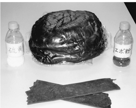
④エポナイト製品⑤硫黄・ゴム・エポ粉を混ぜると下のエポナイトになる
